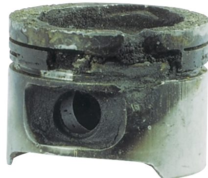
в) прогар верхнего уплотнительного пояса поршня.
