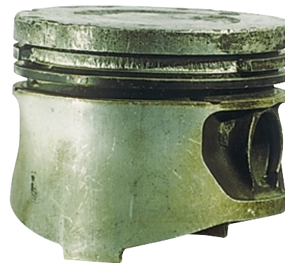
Поломанная перемычка на поршне — типичный результат детонации.
