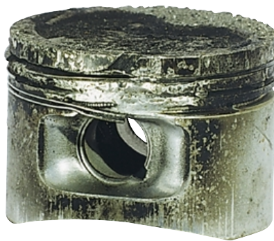
б) начало плавления поврежденного поршня;
